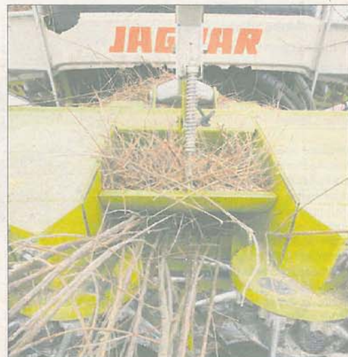
Skærebordet er monteret med enten regulære savklinger, der saver pileskuddene over (som på foto). Eller med skiver med grove tænder der slår pileskuddene over, og kan efterlade fløse-stubbe. Foto: Jens Tønnesen.
