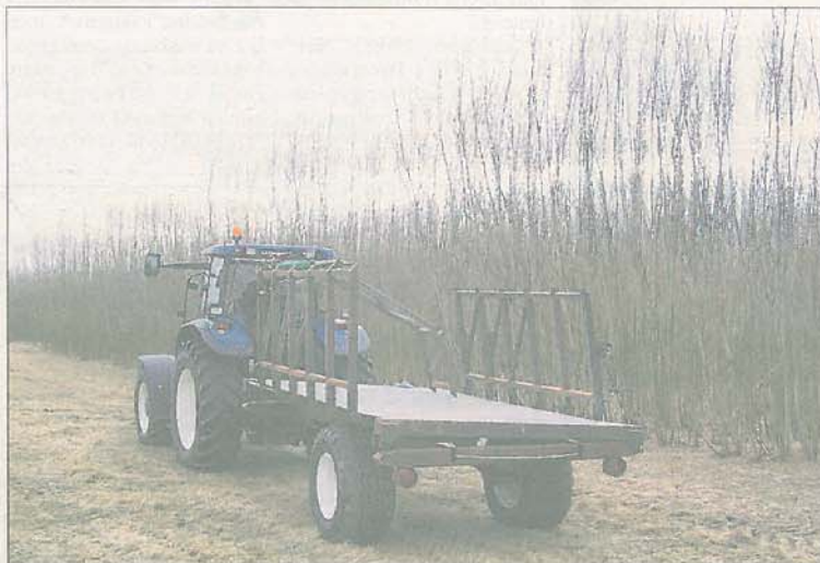
Høstkapaciteten er dobbelt så stor, når, når pilen køres fra med traktor og vogn, frem for at selve pilehøsteren både høster og kører fra. Foto: Agrotech.
